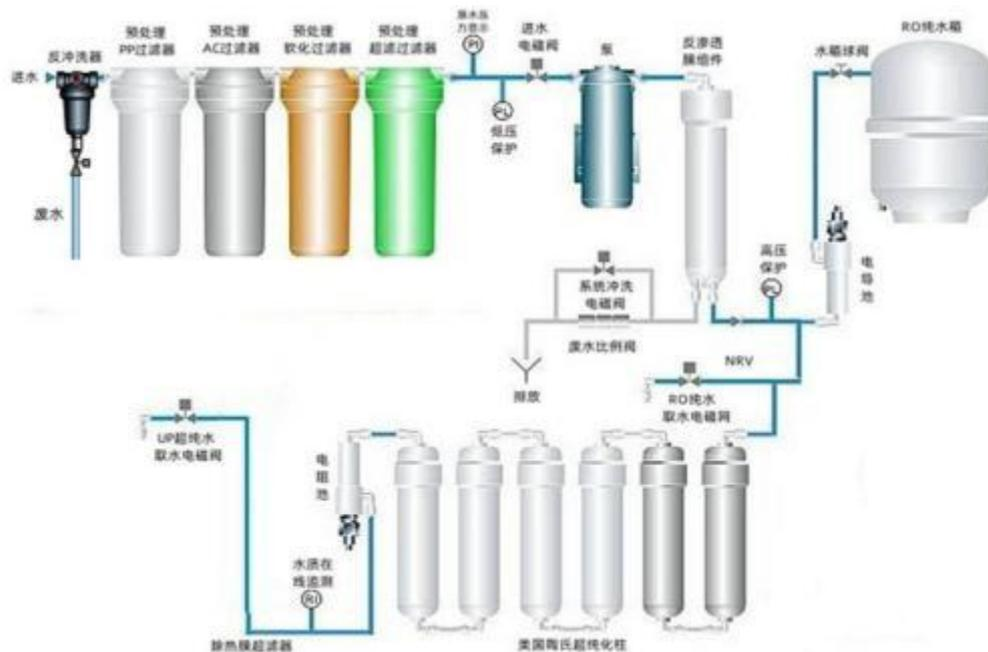
图 2-1 项目纯水制备工艺流程图
