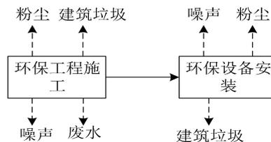
图 2-2 施工阶段程序及其产污节点示意图
