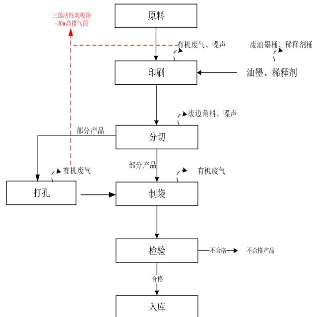
图 2-3 项目生产工艺流程及产污节点示意图
