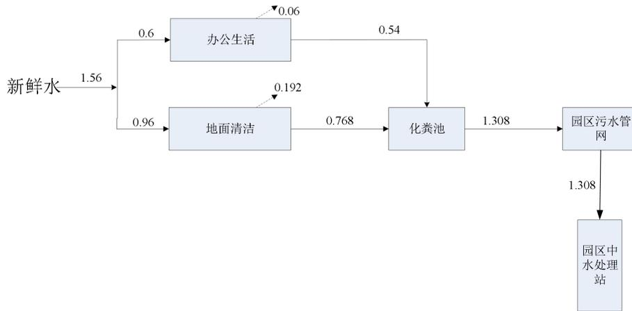
图 2-1 项目水量平衡图 (m<sup>3</sup>/d)
