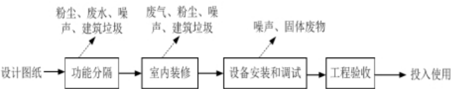
图 2.8-1 施工期生产工艺流程图及产污节点图
