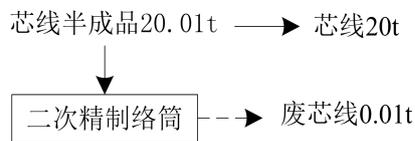
图 2-3 芯线生产线物料平衡图
