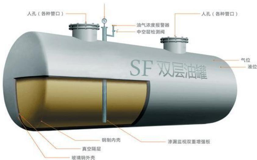
图 2-8 双层油罐剖面图
