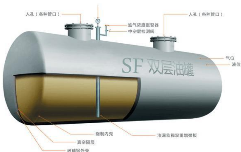
图 2-8 双层油罐剖面图
