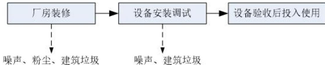
图 2-1 施工期工艺流程及产污环节示意图
