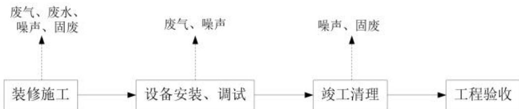
图 2-3 施工期工艺流程及产污节点图
