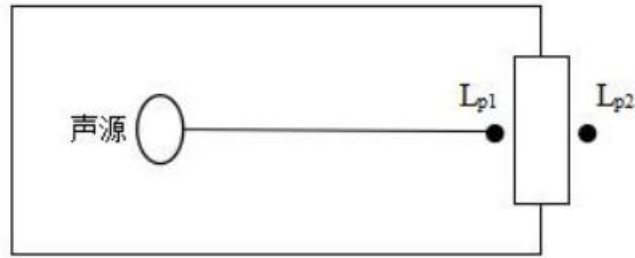
图 4-2 室内声源等效为室外声源图例
