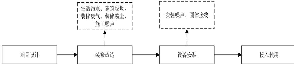
图 2-2 施工期工艺流程及产污节点图
