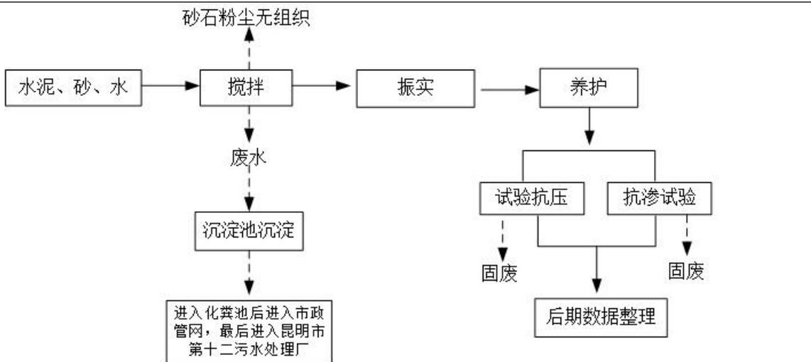
图 2-6 水泥试验流程图
