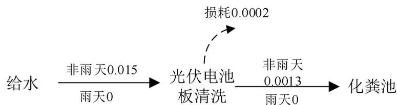
图2-16 光伏清洗水平衡图（光伏电池板清洗时） m<sup>3</sup>/d
