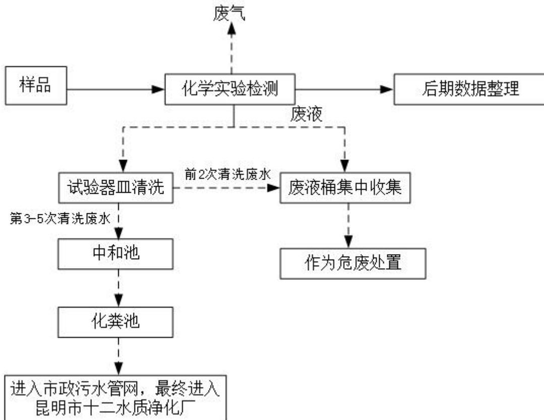
图 2-11 运营期化学实验工艺流程及产污环节示意图
