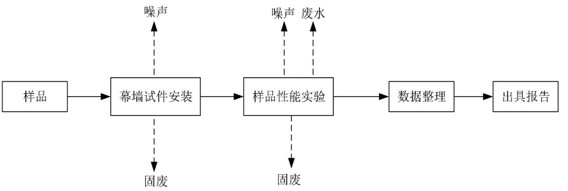
图 2-9 幕墙四性检测工艺流程及产污环节示意图
