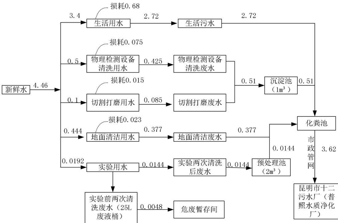
图2-1 项目水平衡图 (m<sup>3</sup>/d)
