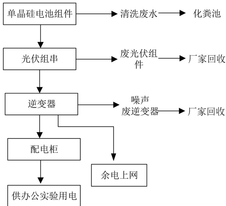
图 2-15 屋顶光伏工艺流程产污节点图
