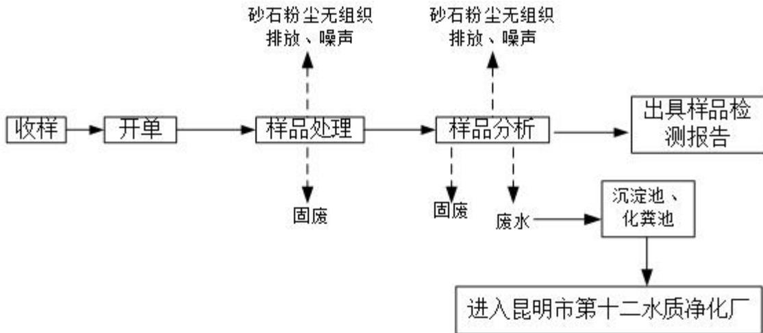
图 2-4 物理实验流程图
