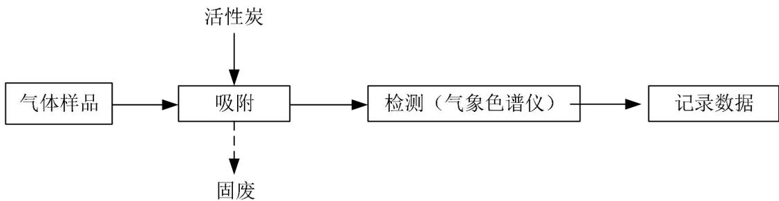
图 2-13 空气中苯和 TVOC 测定工艺流程
