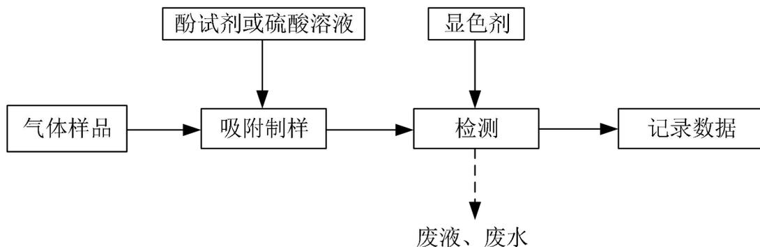
图 2-12 空气中甲醛、氨测定工艺流程
